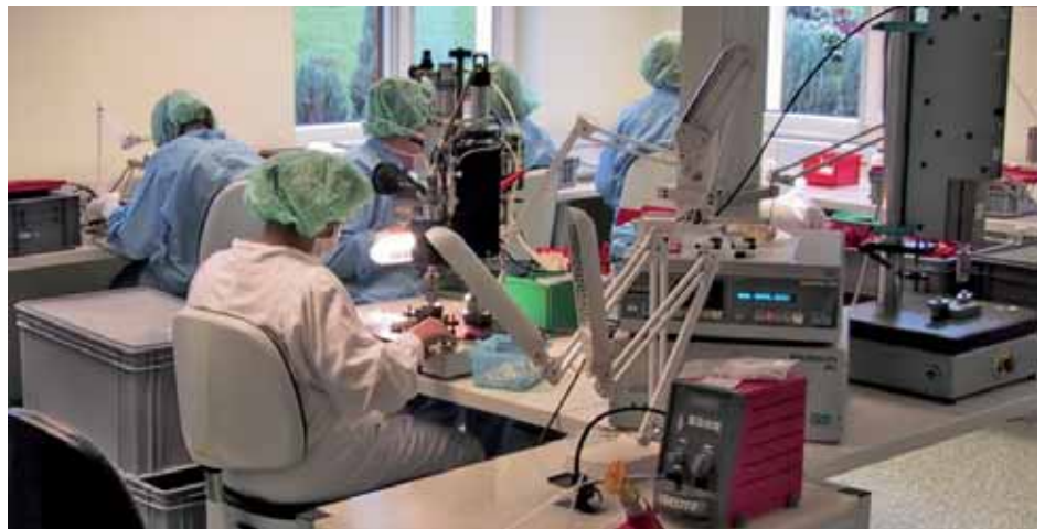
Produktion in Metall und Kunststoff: Im Reinraum der Klasse 100.000 werden medizinische Einwegprodukte assembliert und verpackt.
