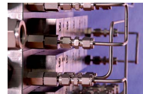
Mikroreaktionstechnologie in einem Kapillarreaktor kompakt verbaut.
